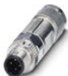
Connettori, PROFINET CAT5 (100 MBit/s), 4-poli, senza alogenati, schermata, Maschio diritto M12 SPEEDCON, codifica D, Attacco a crimpare, materiale zigrinato: Pressogetto di zinco, nichelato, diametro esterno cavo 5,5 mm ... 10 mm, con contatti a crimpare
