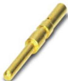
Contatto a crimpare, diametro contatti: 1 mm, tornito, Maschio, materiale contatti: CuZn, superficie contatti: Ni/Au, sezione di connessione: 0,34 mm<sup>2</sup> ... 1 mm<sup>2</sup> AWG 22 ... 18
