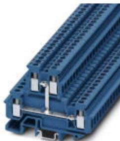
Minimorsetto passante, con ripartitore di potenziale, collegamento: Connessione a vite, sezione: 0,2 mm<sup>2</sup> - 4 mm<sup>2</sup>, AWG: 24 - 12, larghezza: 5,2 mm, colore: blu, tipo di montaggio: NS 15, NS 35/7,5, NS 35/15
