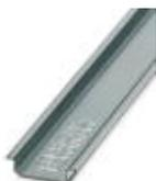
Guida di supporto, non perforata, Profilo standard, larghezza: 35 mm, altezza: 7,5 mm, a norma EN 60715, materiale: Acciaio, zincato, passivato bianco, lunghezza: 2000 mm, colore: color argento
