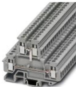
Minimorsetto passante, per il montaggio di componenti selezionabili a piacere, tensione nominale: 500 V, corrente nominale: 24 A, collegamento: Connessione a vite, sezione: 0,2 mm<sup>2</sup> - 4 mm<sup>2</sup>, AWG: 24 - 12, lunghezza: 62 mm, larghezza: 5,2 mm, colore: grigio, montaggio: NS 15, NS 35/7,5, NS 35/15
