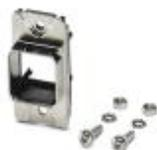
Telaio di montaggio RJ45 per transceiver, IP67, per bloccaggio Push-Pull, metallo, per sezione di montaggio rettangolare, con guarnizione e viti di fissaggio
