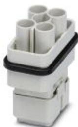
Inserto portacontatti a crimpare HEAVYCON per custodia compatta in plastica; maschio; circuito di potenza 4 poli + PE, circuito di comando 2 poli
