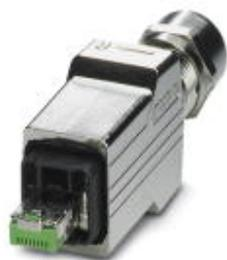
Connettore RJ45, grado di protezione: IP65/IP67, numero poli: 8, 1 Gbit/s, CAT5 (IEC 11801:2002), materiale: Acciaio legato 1.4404, collegamento: Connessione rapida IDC, sezione di connessione: AWG 23-22, uscita cavo: diritto
