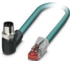
Cavo di rete, Ethernet CAT5 (100 MBit/s), 4-poli, PUR senza alogenati, azzurro mare RAL 5021, schermata, Maschio angolato M12 SPEEDCON / IP67, codifica: D, su Maschio diritto RJ45 / IP20, lunghezza cavo: 2 m
