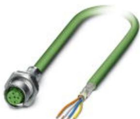
Connettore femmina da incasso, schermato, 4 poli, M12, codifica D, montaggio posteriore/a vite con filettatura M16, con cavo da 5 m, 4 x 0,34 mm<sup>2</sup>
