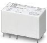
Relè di potenza in miniatura a innesto, con contatto Wolfram anticipato per correnti di inserzione elevate fino a 800 A di picco, 1 contatto di chiusura, tensione di ingresso: 24 V DC
