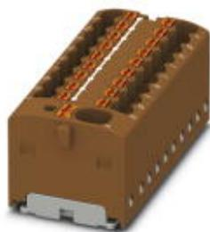
Blocco distributore, ponticellato internamente, corrente nominale: 41 A, collegamento: Connessione Push-in, Connessione Push-in, numero di connessioni: 19, sezione: 0,2 mm<sup>2</sup> - 6 mm<sup>2</sup>, AWG: 24 - 12, larghezza: 43,9 mm, altezza: 18,7 mm, colore: marrone, tipo di montaggio: incollare
