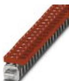
Morsetto di collegamento, collegamento: Connessione a vite, corrente di carico: 41 A, sezione: 0,5 mm<sup>2</sup> - 6 mm<sup>2</sup>, larghezza: 7 mm, colore: rosso
