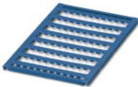
Segnamorsetti, Scheda, blu, in bianco, siglabilie con: BLUEMARK ID, BLUEMARK ID COLOR, BLUEMARK CLED, PLOTMARK, CMS-P1-PLOTTER, tipo di montaggio: inserimento a scatto in scanalatura piatta portacartellini, per morsetti con spessore: 6 mm, dimensioni campo di siglatura: 5,45 x 5,2 mm, Numero dei cartellini singoli: 80
