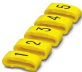
Segnafile, giallo, longitudinale: Simboli, tipo di montaggio: infilamento, diametro cavo: > 16 mm, dimensioni campo di siglatura: 4,3 x 2,6 mm
