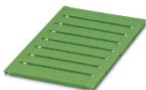
Segnamorsetti, Scheda, verde, in bianco, siglabile con: BLUEMARK ID COLOR, BLUEMARK ID, BLUEMARK CLED, PLOTMARK, CMS-P1-PLOTTER, tipo di montaggio: inserimento a scatto in scanalatura alta portacartellini, per morsetti con spessore: 16 mm, dimensioni campo di siglatura: 15,45 x 10,5 mm, Numero dei cartellini singoli: 32
