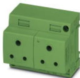
Pres a doppia, Tipo: D, Connessione a vite, per India / Africa e altri paesi, con spia luminosa, verde, per montaggio su guida di montaggio nell'interfaccia di servizio o per montaggio diretto, 250 V AC, 6 A, -20 °C, 60 °C, IS 1293
