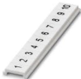
Nastro Zack piatto, Striscia, bianco, siglato, siglatura longitudinale: numeri progressivi 1 ...10, 11 ...20 ecc. fino a 91 ...100, tipo di montaggio: inserimento a scatto in scanalatura piatta portacartellini, per morsetti con spessore: 3,5 mm, dimensioni campo di siglatura: 5,15 x 3,5 mm, Numero dei cartellini singoli: 10
