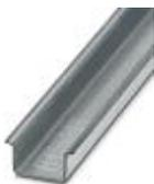
Guida di supporto, non perforata, Profilo standard, larghezza: 35 mm, altezza: 15 mm, simile a norma EN 60715, materiale: Acciaio, zincato, lunghezza: 2000 mm, colore: color argento
