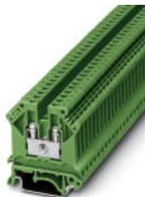
Morsetto passante, tensione nominale: 800 V, corrente nominale: 24 A, collegamento: Connessione a vite, numero di connessioni: 2, sezione: 0,2 mm<sup>2</sup> - 4 mm<sup>2</sup>, AWG: 24 - 12, larghezza: 5,2 mm, colore: verde, tipo di montaggio: NS 35/7,5, NS 35/15, NS 32
