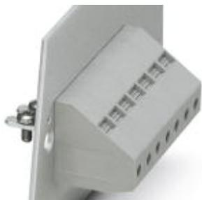
Morsetto passaparete, collegamento: Connessione a vite con gabbia, Attacco capocorda, numero poli: 1, corrente di carico: 76 A, sezione: 0,5 mm<sup>2</sup> - 25 mm<sup>2</sup>, direzione di connessione del conduttore alla direzione di inserzione: -90°, larghezza: 12,1 mm, colore: blu
