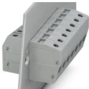
Morsetto passaparete, collegamento: Connessione a vite con gabbia, Connessione a vite con gabbia, numero poli: 1, corrente di carico: 76 A, sezione: 0,5 mm<sup>2</sup> - 25 mm<sup>2</sup>, direzione di connessione del conduttore alla direzione di inserzione: 0 °, larghezza: 12,1 mm, colore: grigio
