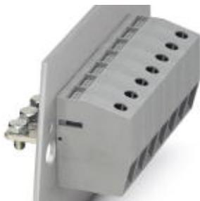
Morsetto passaparete, collegamento: Connessione a vite con gabbia, Attacco capocorda, numero poli: 1, corrente di carico: 101 A, sezione: 6 mm<sup>2</sup> - 35 mm<sup>2</sup>, direzione di connessione del conduttore alla direzione di inserzione: 0 °, colore: grigio
