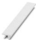
Nastro Zack, Striscia, bianco, in bianco, siglabile con: PLOTMARK, CMS-P1-PLOTTER, tipo di montaggio: inserimento a scatto in scanalatura alta portacartellini, per morsetti con spessore: 16 mm, dimensioni campo di siglatura: 16 x 10,5 mm, Numero dei cartellini singoli: 50
