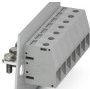
Morsetto passaparete, collegamento: Connessione a vite con gabbia, Attacco capocorda, numero poli: 1, corrente di carico: 150 A, sezione: 16 mm<sup>2</sup> - 50 mm<sup>2</sup>, direzione di connessione del conduttore alla direzione di inserzione: 0 °, larghezza: 18,8 mm, colore: grigio
