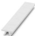
Nastro Zack, Striscia, bianco, in bianco, siglabile con: PLOTMARK, CMS-P1-PLOTTER, tipo di montaggio: inserimento a scatto in scanalatura alta portacartellini, per morsetti con spessore: 12,2 mm, dimensioni campo di siglatura: 12 x 10,5 mm, Numero dei cartellini singoli: 5
