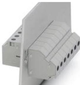
Morsetto passaparete, collegamento: Connessione a vite con gabbia, Connessione a vite con gabbia, numero poli: 1, corrente di carico: 57 A, sezione: 0,5 mm<sup>2</sup> - 16 mm<sup>2</sup>, direzione di connessione del conduttore alla direzione di inserzione: -90 °, larghezza: 10,1 mm, colore: grigio
