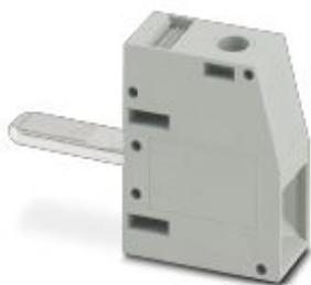
Morsetto passaparete, collegamento: Connessione a vite con gabbia, Connessione a vite con gabbia, numero poli: 1, corrente di carico: 150 A, sezione: 16 mm<sup>2</sup> - 50 mm<sup>2</sup>, direzione di connessione del conduttore alla direzione di inserzione: 0 °, colore: grigio
