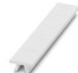
Nastro Zack, Striscia, bianco, in bianco, siglabile con: PLOTMARK, CMS-P1-PLOTTER, tipo di montaggio: inserimento a scatto in scanalatura alta portacartellini, per morsetti con spessore: 12,2 mm, dimensioni campo di siglatura: 12 x 10,5 mm, Numero dei cartellini singoli: 5
