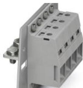
Morsetto passaparete, collegamento: Connessione a vite con gabbia, Attacco capocorda, numero poli: 1, corrente di carico: 232 A, sezione: 35 mm<sup>2</sup> - 95 mm<sup>2</sup>, direzione di connessione del conduttore alla direzione di inserzione: 0 °, larghezza: 25 mm, colore: grigio
