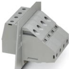
Morsetto passaparete, collegamento: Connessione a vite con gabbia, Connessione a vite con gabbia, numero poli: 1, corrente di carico: 232 A, sezione: 25 mm<sup>2</sup> - 95 mm<sup>2</sup>, direzione di connessione del conduttore alla direzione di inserzione: -90 °, larghezza: 25 mm, colore: grigio
