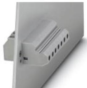
Morsetto passaparete, collegamento: Connessione a vite con gabbia, Connessione a vite con gabbia, numero poli: 1, corrente di carico: 32 A, sezione: 0,2 mm<sup>2</sup> - 6 mm<sup>2</sup>, direzione di connessione del conduttore alla direzione di inserzione: -90 °, larghezza: 8,1 mm, colore: grigio
