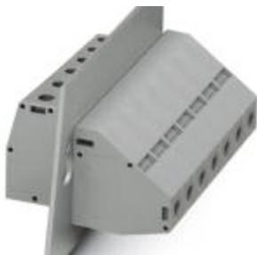
Morsetto passaparete, collegamento: Connessione a vite con gabbia, Connessione a vite con gabbia, numero poli: 1, corrente di carico: 150 A, sezione: 16 mm<sup>2</sup> - 50 mm<sup>2</sup>, direzione di connessione del conduttore alla direzione di inserzione: -90 °, larghezza: 18,8 mm, colore: grigio
