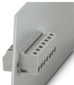
Morsetto passaparete, collegamento: Connessione a vite con gabbia, Connessione a vite con gabbia, numero poli: 1, corrente di carico: 32 A, sezione: 0,2 mm<sup>2</sup> - 6 mm<sup>2</sup>, direzione di connessione del conduttore alla direzione di inserzione: 0 °, larghezza: 8,1 mm, colore: nero
