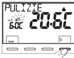
2- Sul display compare la scritta **OFF**, ad indicare che il termostato è disattivato e tutte le funzioni sono inattive; rimangono in funzione la lettura della temperatura ambiente, la modalità anticalcare se attivata e se in modalità INVERNO il Set di temperatura più il simbolo di protezione antigelo t ❄️.
