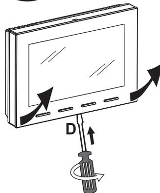
Sganciare il termostato dalla base a parete premendo con un cacciavite nell'apposita cava D presente nella parte inferiore del dispositivo, quindi ruotarlo per estrarlo.
