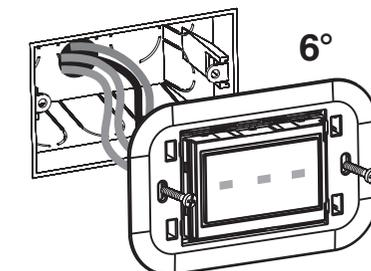
Eseguire i collegamenti elettrici come da schemi raffigurati nelle apposite istruzioni e fissare il telaietto 1PAT005 alla scatola tipo 503 incassata a muro
