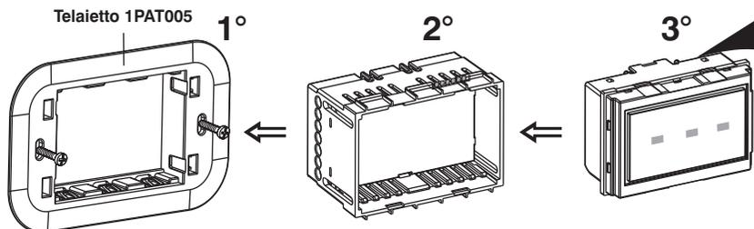
Inserire il dispositivo nel telaietto 1PAT005 sino al bloccaggio
