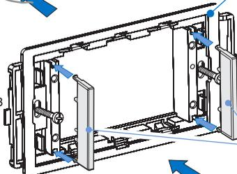
Fissare il Telaio "T2" alla scatola ad incasso tipo 503
