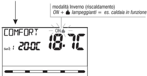
**Il termostato è operativo**, visualizza sul display: la modalità **Inverno** «riscaldamento», il Set di temperatura a 20°C COMFORT, la temperatura ambiente rilevata.
