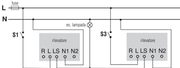
**Nota:** al rilevatore è possibile collegare un pulsante (S2, S4) per permettere il funzionamento manuale.
