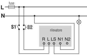
**Esempio: per collegare due Rilevatori ad un'unica lampada, attenersi al seguente schema di cablaggio:**
