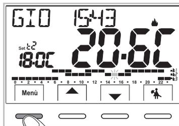
**Funzionamento manuale temporaneo** (vedere descrizione completa al par.10.2.1.A)
