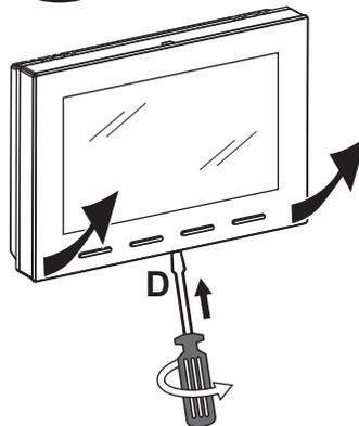
Sganciare il cronotermostato dalla base a parete premendo con un cacciavite nell'apposita cava **D** presente nella parte inferiore del dispositivo, quindi estrarlo.
