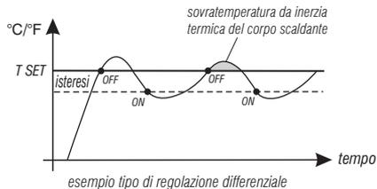
**In alternativa** al Differenziale termico è possibile regolare la temperatura in modo **PROPORZIONALE MODULANTE (PrOP)**; la durata del ciclo è impostabile da 7 a 20 minuti (impostazione di fabbrica 10 minuti). Questo sistema permette di mantenere più stabile la temperatura desiderata, aumentando la sensazione di comfort per l'utente e risparmiando sui consumi energetici.
