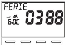
Il cronotermostato inizia il conto alla rovescia (es. in figura: 388 ore) sino all'esaurimento delle ore programmate; in modalità INVERNO farà attivare l'utenza allacciata solo nel caso in cui la temperatura ambiente dovesse scendere sotto il Set di temperatura antigelo impostato (default 6.0 °C). Terminato il conto alla rovescia il programma FERIE reinserirà il Vostro abituale programma.
