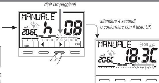
**i** Con la funzione di manuale temporaneo attivata sarà possibile modificare il set di temperatura autonomo in un secondo momento premendo i tasti ▲▼, o la sua durata premendo **OK** e successivamente ◀▶.
