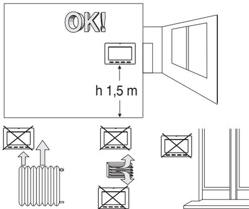
Installare preferibilmente il cronotermostato a quota  $1,50 \div 1,60$  m dal pavimento; lontano da sorgenti di calore, prese d'aria, porte o finestre e da quanto possa influenzarne il funzionamento.
