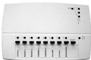
**Modello con BUS di collegamento alla barra dei comandi separata, per il comando di 8 elettrovalvole e il comando della pompa o caldaia, in impianti senza fili per la regolazione della temperatura.**
