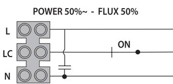
**IT** **Funzionamento riduzione di potenza comando pilota:** Modello equipaggiato con dispositivo che permette di avere una riduzione del flusso luminoso del 50% con una semplice linea supplementare di comando. La linea supplementare è una semplice linea 0-230 V, ed il sistema è programmato per il funzionamento nel seguente modo:
