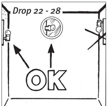
Installazione dell'apparecchio, How to install the luminaire, Installation de l'appareil, Installation der leuchte,
