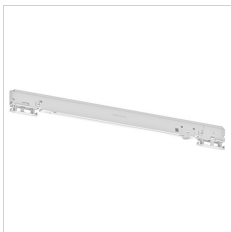
310897 Adattatore integrato DALI a 6 conduttori con driver integrato (3 fasi + sistema di controllo) (350-500 mA - max. 50 VDC)
