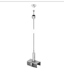
310805 Rosone metallico sferico con foro, cavo in acciaio Ø 1,5 mm lunghezza 3 m con estremità sferica, con tenditore automatico
