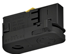
311058 Adattatore asimmetrico a 4 conduttori (3 fasi) (carico massimo 50 N = 5,1 kg)
