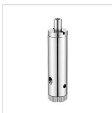
310665 Tenditore automatico M5 con foro laterale, in ottone cromato
