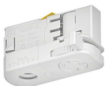
311060 Adattatore asimmetrico a 4 conduttori (3 fasi) (carico massimo 50 N = 5,1 kg)
