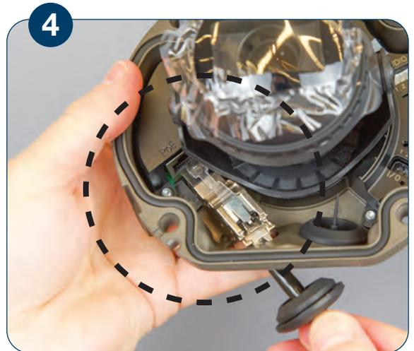
4 Inserte el *Plug* en el puerto y coloque el cubre-filo en la cámara
