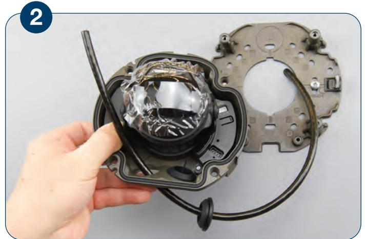
2 Inserte el cable en el orificio de la cámara
