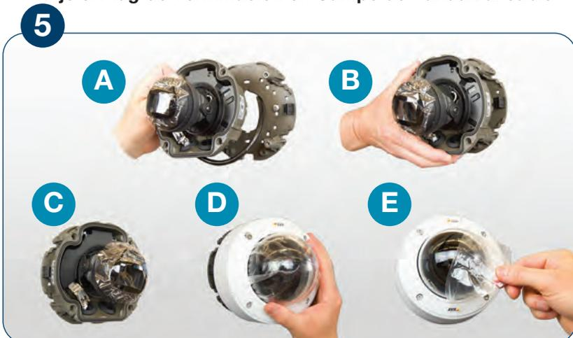
5 Enrute el cable para evitar dobleces, monte la cámara y la cubierta
