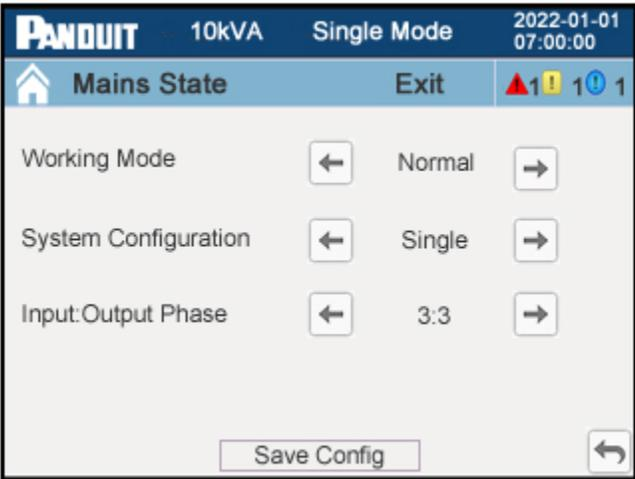
**Figure 43: System Setup Page (3-Phase UPS)**
