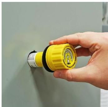
1. Insérer le module d'indication dans le trou de 30 mm de l'ouverture défonçable, tout en alignant l'encoche d'anti-rotation. S'assurer que la rondelle en caoutchouc est placée à l'extérieur de l'enveloppe.
