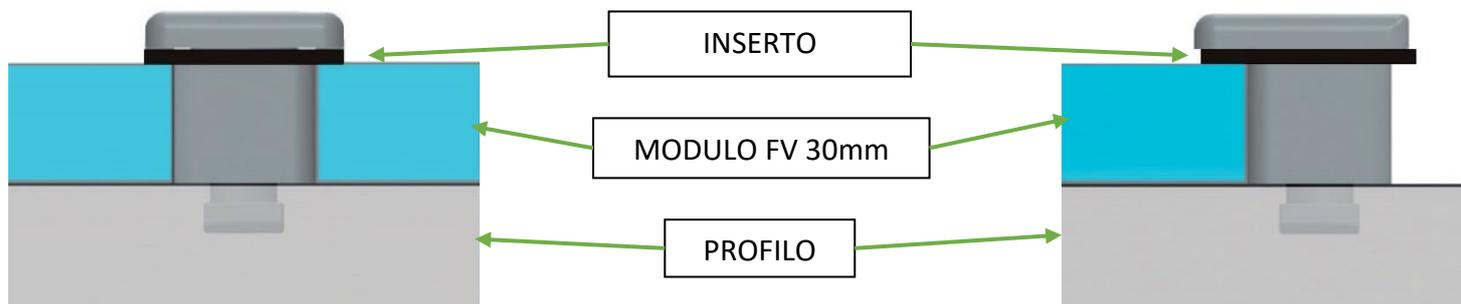
Per consentire il corretto funzionamento dell'inserto compensatore durante l'installazione verificare che la gomma, quando il morsetto MPU viene posizionato, non risulti schiacciata tra la testa ed il corpo del morsetto:
