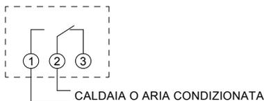
Per controllare l'installazione attraverso dei teleruttori è consigliabile porre un condensatore con un valore adeguato (0,1µF 275 V~) nella bobina del medesimo.
