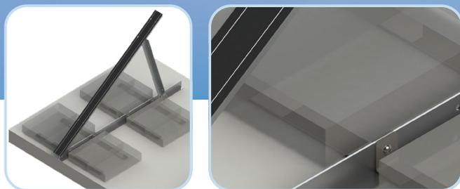
**P**ZAV315 è un kit di due staffe supporto che abbinato ai triangoli consente di zavorrare la struttura alla superficie di appoggio. Le staffe realizzate in acciaio inox AISI 304 sono state studiate per essere fissate tramite vite e dado alla base del triangolo, mantenendolo complanare al piano di appoggio. La superficie delle staffe consente di appoggiare differenti tipologie di zavorre (in cemento, sacchi di sabbia,...) con misure e pesi diversi.
