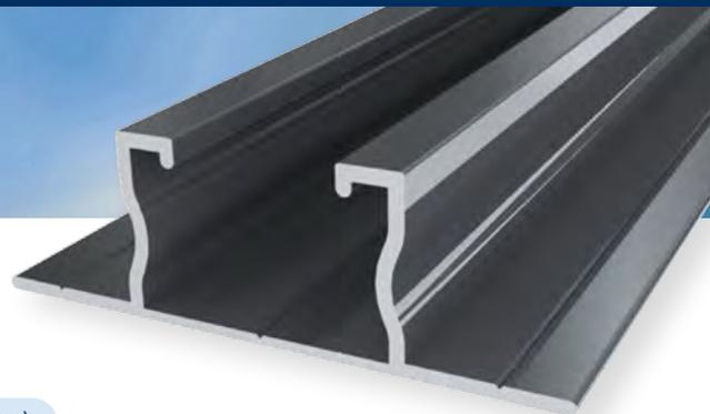
**E**ASY WING SMALL è un profilato di sostegno in alluminio particolarmente adatto per l'ancoraggio dei pannelli fotovoltaici su tettoie di edifici realizzate con pannelli isolanti e coperture grecate. EASY WING SMALL è dotato di una base di appoggio a due ali, che semplifica l'installazione alla tettoia e ne migliora l'ancoraggio.
